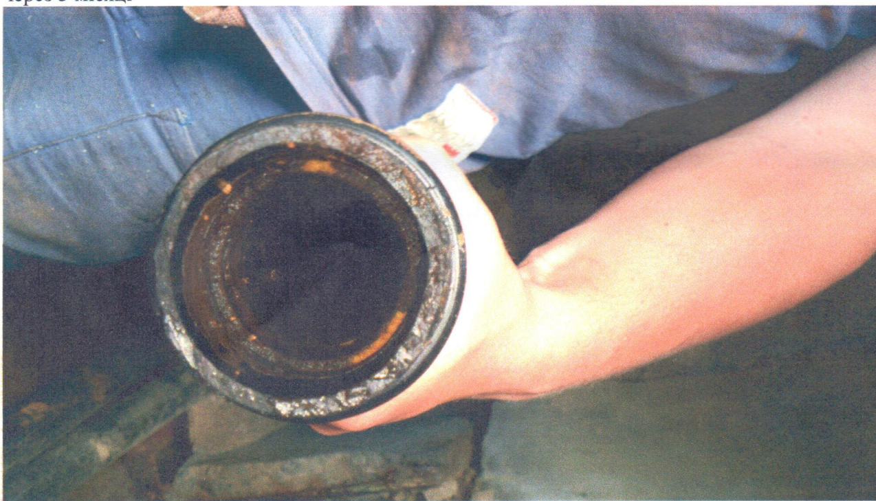
Фото 6 . контрольна точка 2 (лінія, що мала шар карбонату кальцію на початку експерименту) через 3 місяці
