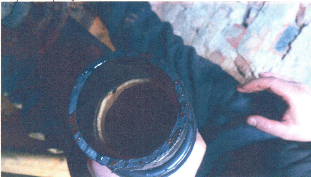
Фото 5 . контрольна точка 2 (лінія, що мала шар карбонату кальцію на початку експерименту) до використання приладу
